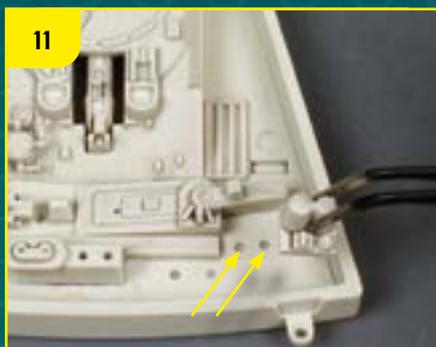
Вклейте деталь 8 в отмеченные отверстия.
