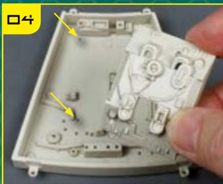
Деталь 2 крепится в четыре отверстия в нише (на изображении отмечены только два).
